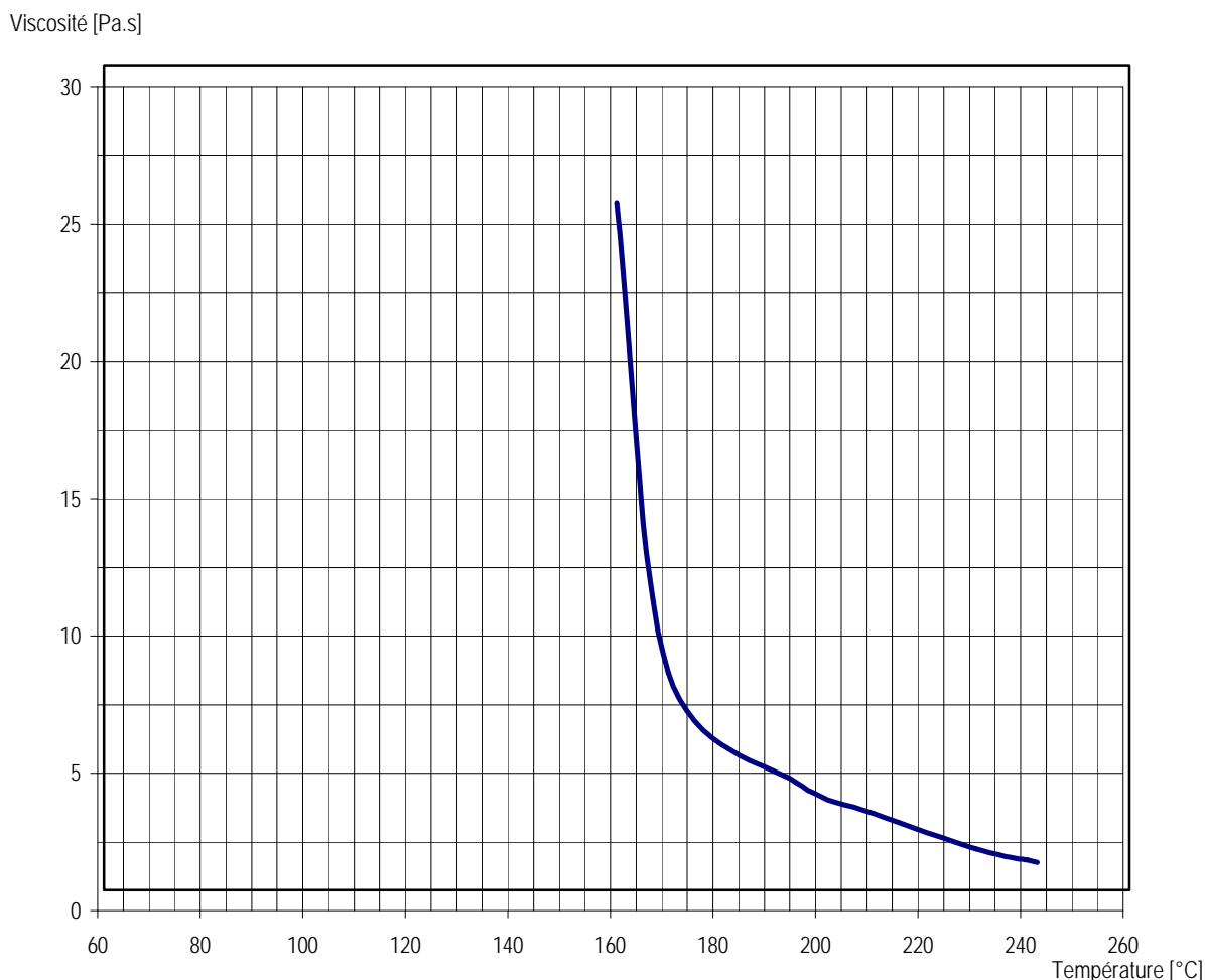
Courbe de viscosité en fonction de la température Viscosity curve versus temperature
